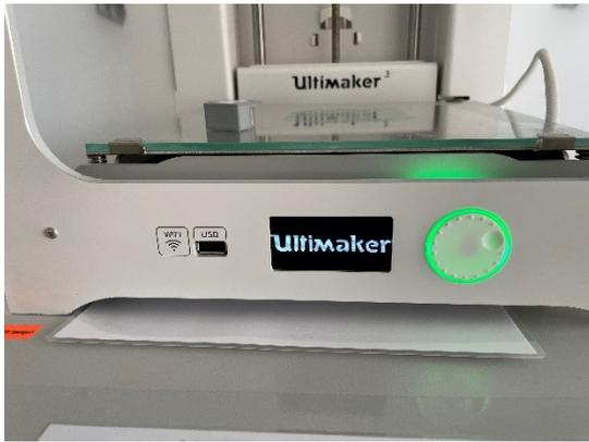
Stecken Sie den USB-Stick mit dem in Cura erstellten Druck in den Ultimaker und wählen Sie Drucken:
